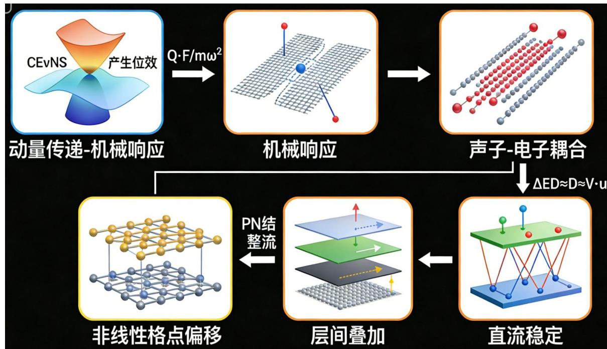
当中微子通过 CEvNS 效应与靶核发生作用时，会产生约  $10^{-13}$  米的微小位移，这一近乎不可感知的振动，需经过“动量传递 - 机械响应 - 声子 - 电子耦合 - 非线性整流 - 层间叠加 - 直流稳定”六级流程转化为稳定直流电，放大的本质是四大核心机制的协同作用，严格遵循能量守恒：
